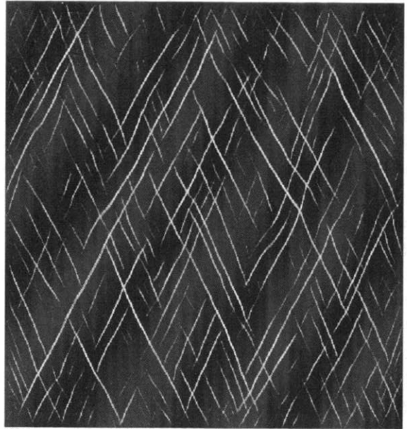
그림 4. 수치적 시뮬레이션으로 보여진 알갱이계에 나타나는 전형적인 층밀림띠(shear band)의 그물. 각 변의 길이가 500 단위세포인 사각격자가 사용되었고, 그림에 나타난 색은 각 부분의 국소적인 층밀림속도(shear velocity)에 따라 정해진다.
